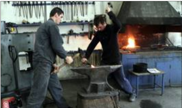
Yoan (à gauche) et Victor donnent la forme souhaitée à la tige de fer rougie et chauffée à plus de 800°.
